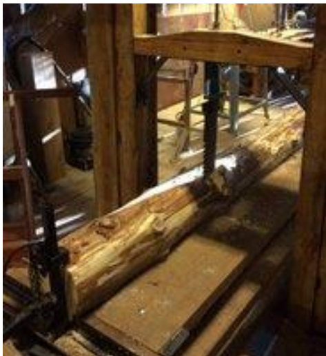
En ramsåg kunde ha ett eller flera sågblad för att såga stockar till plank eller bräder. Sågbladen satt fast i en ram som rörde sig upp och ner. Här är en enbladig ramsåg vid Landsnora såg i Sollentuna.
