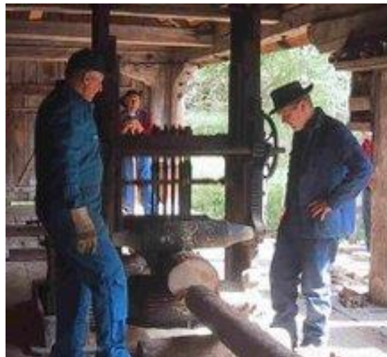
Bilden visar en flerbladig ramsåg vid Hässlevedet i Östergötland. Skysta sågkvarn var försedd med två flerbladiga ramar och hade således mycket stor kapacitet.
